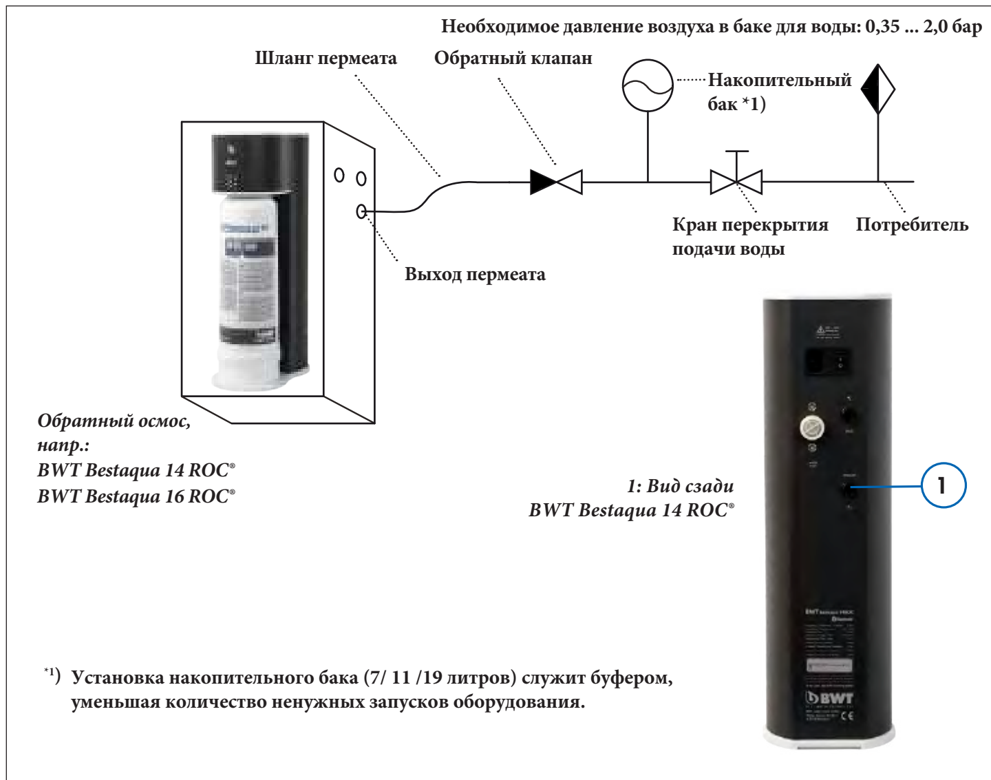
Рис. 4: Схема установки комплектов накопительных баков BWT к потребителю
